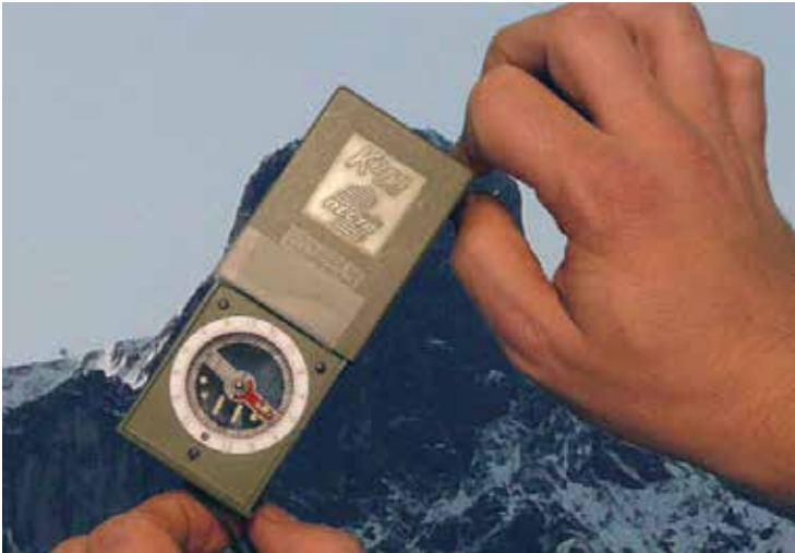
Abbildung 9 Messen von Geländewinkeln mit Index-Segment und rotem Teilkreis
