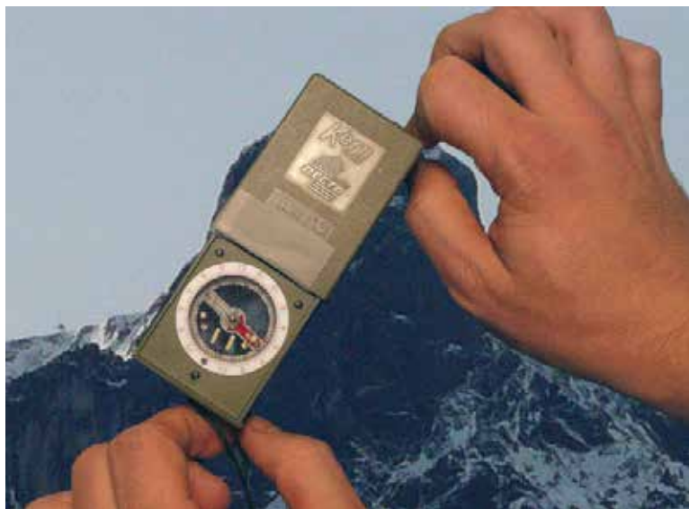
Figure 9 Mesure d'angle de site avec l'index et cercle gradué en rouge
